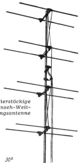
Bild 6. Vierstöckige Fernseh-Weitempfangsantenne
