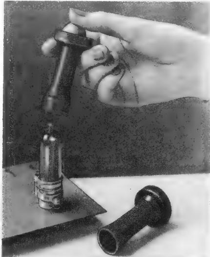
**Achtung auf Masseverbindungen beim Einbau von UKW-Vorsatzgeräten**
