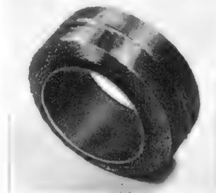
Bild 5. Kreuzwickelspule als Ersatz für den bisherigen Zeilentransformator
