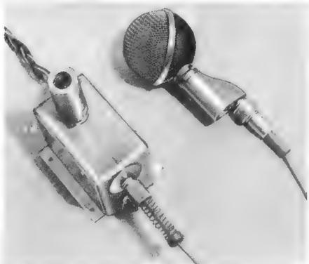
Bild 3. Gesamtansicht des einbaufertigen Vorverstärkers mit Amateurmikrofon
